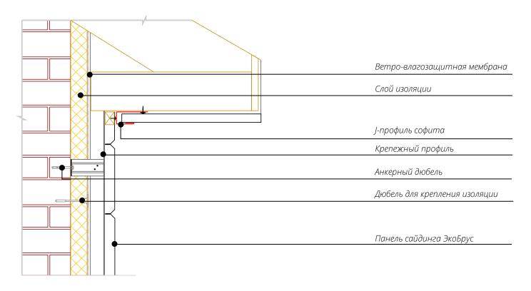
Узел 1.11 Финиш с помощью простого угла. Вертикальный разрез.
