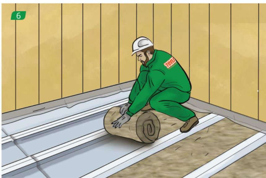
Укладываем утеплитель между балками.
