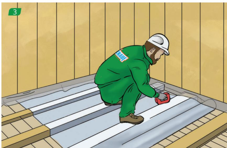
Раскатываем ветро-гидрозащитную мембрану поперек балок и фиксируем к балкам степлером.
