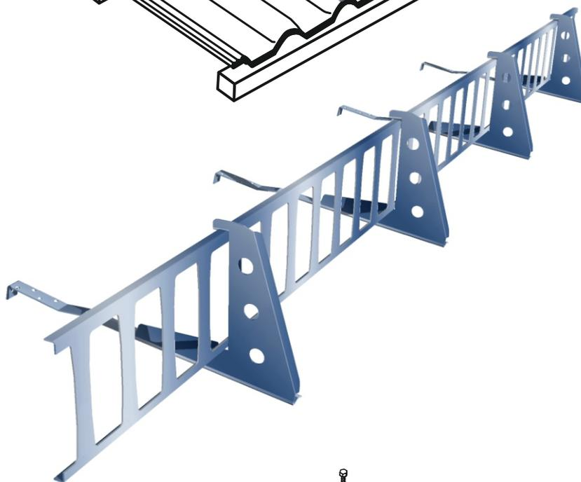
3. Зафиксировать решетку саморезом через отверстие на опоре.
