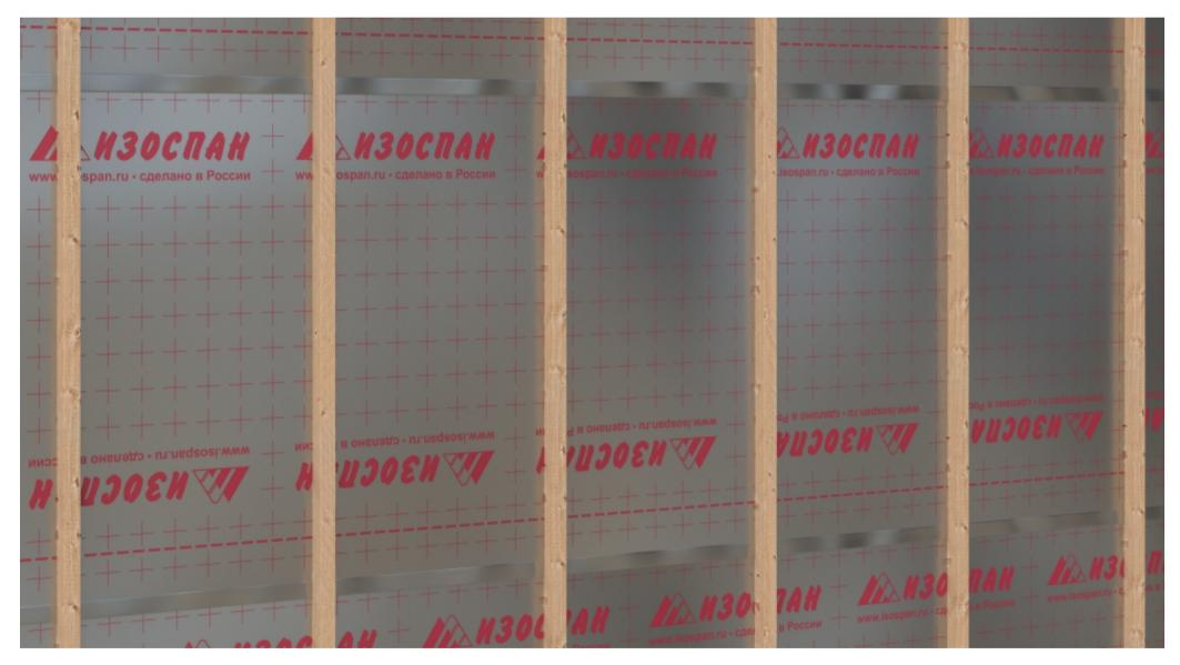
Внутренняя отделка крепится к реечному каркасу с зазором 4-5 см между отражающей пароизоляцией и отделкой.
