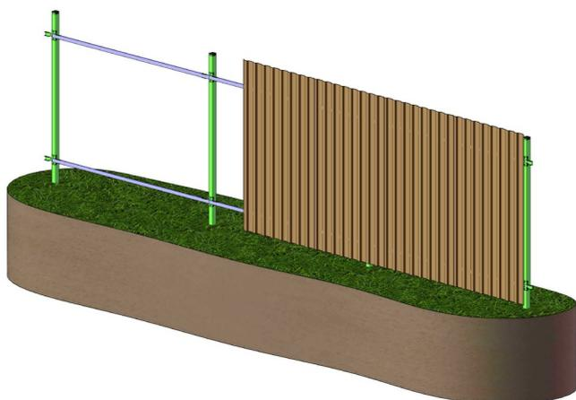
1. Установите панель на необходимую высоту (регулировать высоту можно, подложив под панель деревянные бруски), проверьте горизонтальность панели с помощью уровня.
