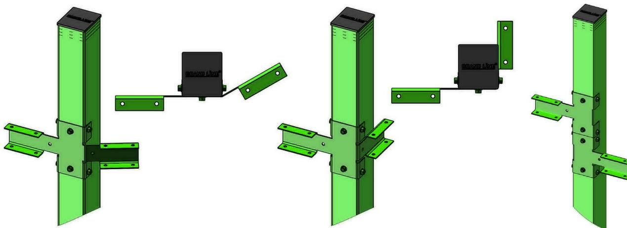
При необходимости панели можно закрепить ступенчато. Для этого на столб закрепляются дополнительные X-кронштейны. Таким образом можно нивелировать неровности грунта. Неиспользуемое ухо X-кронштейна можно отпилить.
