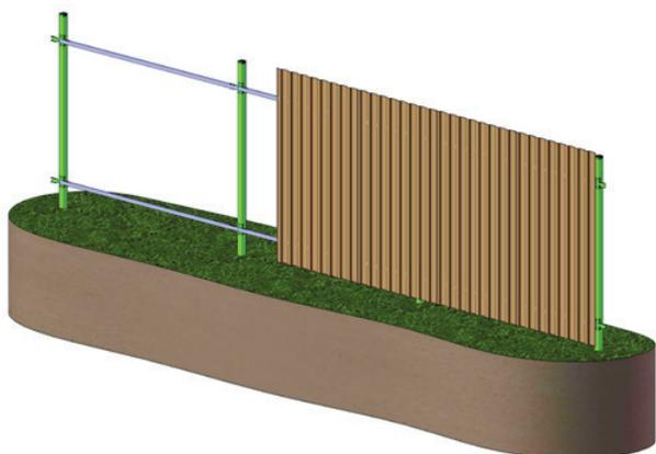
Для ограждений используйте стеновые профили С8А, С10А, В, С20А, В или фигурные версии этих профилей. Для увеличения жесткости забора допускается использовать профиль С21R.
