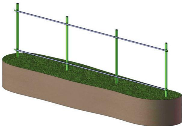
1. Установите трубы 40x20 длиной 2500 или 3000 мм в X-кронштейны и зафиксируйте их саморезами (5,5x19 мм). Торец трубы 40x20 должен совпадать с осью столба.
