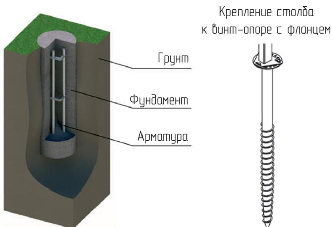
В качестве фундамента под столб с фланцем может применяться любой вид фундамента (ленточный, монолитный и т. д.), винт-опоры, забивные сваи.
