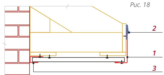
■ Вставьте панель в J-профиль **3**, оставив между ними небольшой зазор, закрепите панель к обрешетке.
