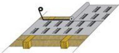
Если толщина стропил больше толщины утеплителя, пленку необходимо прижать к боковой поверхности стропил при помощи реек 2Х3 см или скобами строительного степлера. Нижняя кромка пленки должна обеспечивать удаление стекающей влаги в водоотводной желоб крыши. После установки пленочного покрытия оно закрепляется при помощи контрреек 3х5 см, которые прибиваются сверху вдоль стропил оцинкованными гвоздями.
