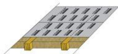
Поверх контрреек устанавливается обрешетка в соответствии с применяемой кровельной системой.
