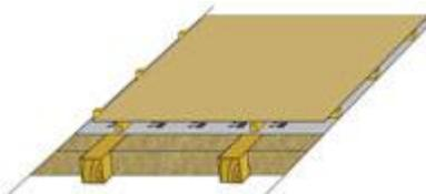
Его толщина, как правило, определяется толщиной контррейки и обрешетки и составляет 8-10 см. Для обеспечения доступа внешнего воздуха в вентилируемый зазор и удаления паров воды в подшивке карниза предусматриваются вентиляционные отверстия, а в районе конька вентиляционные устройства, соответствующие применяемой кровельной системе.
