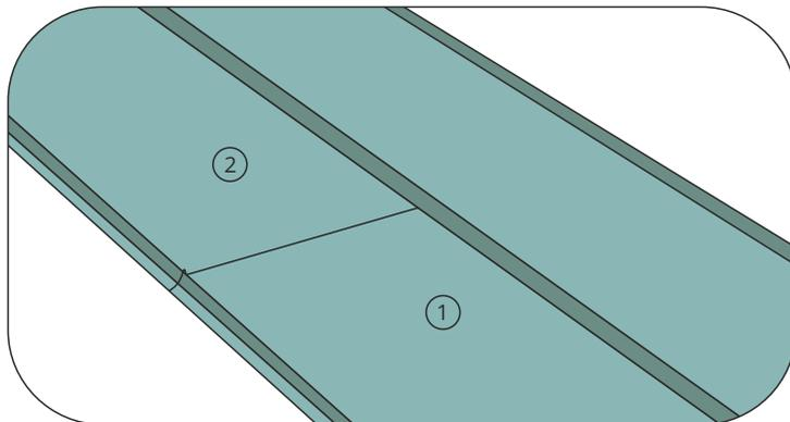
Если длина ската кровли больше длины панелей, монтаж производится с нахлестом около 100 мм. Панели укладываются в шахматном порядке, минимальное расстояние между стыками – 500 мм.
