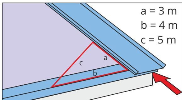
Уложите панель на скат, отступив 50 мм от края торца. Убедитесь, что панель расположена строго под углом  $90^\circ$  по отношению к карнизу. Для контроля прямого угла зафиксируйте картину одним саморезом в нижней точке. Отложите вдоль картины 3 м, вдоль карниза 4 м. Если гипотенуза треугольника будет равна 5 м, лист можно крепить, так как он находится точно под углом  $90^\circ$  к карнизной планке.
