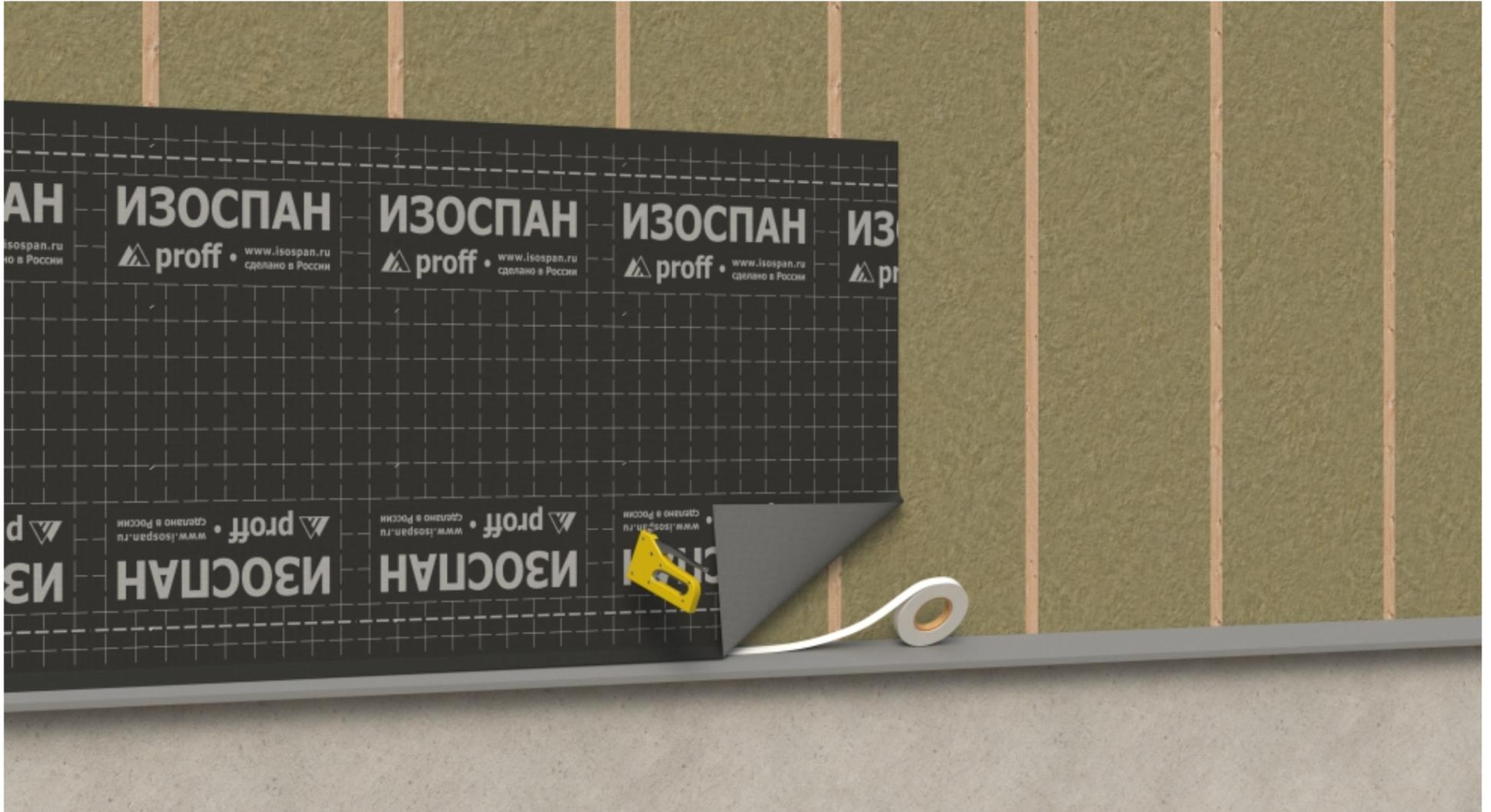
Если остатка рулона не хватает на всю ширину стены, то вертикальный нахлест полотен мембраны выполняется на балке каркаса. Излишек уложенного материала обрезается вдоль балки каркаса.
