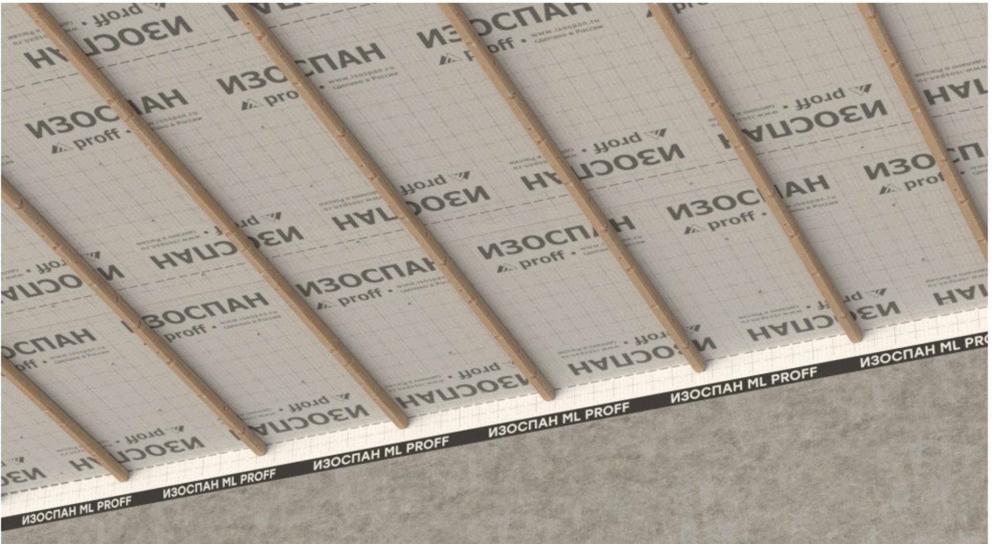
Внутренняя отделка крепится к реечному каркасу или оцинкованным профилям с зазором 4–5 см между пароизоляцией и отделкой.
