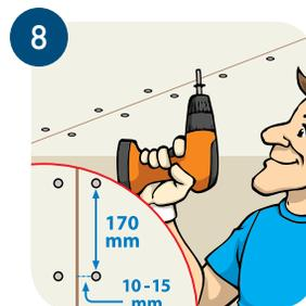
8 Монтируем КНАУФ-листы к каркасу. Шаг крепления не более 170 мм.
