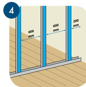
4 Наносим на наружную сторону стоечного профиля уплотнительную ленту КНАУФ. Шаг крепления от боковых стен не более 200 мм, далее шаг не более 600 мм.
