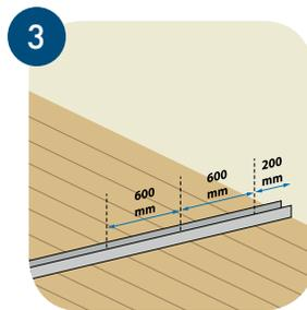
3 Фиксируем направляющие профили дюбелями к полу и потолку. Шаг крепления не более 600 мм. От стены не более 200 мм.
