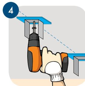
4 Устанавливаем подвесы с прокладкой уплотнительной лентой.
