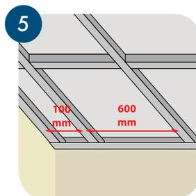
5 Монтируем направляющие и потолочные профили. Проводим выравнивание каркаса с помощью подвесов.
