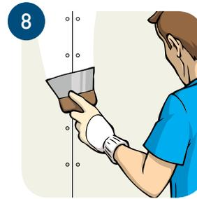
8 Выполняем облицовку второй стороны перегородки. Наносим шпаклевку на стыковочные швы. Установка КНАУФ-листов выполняется со смещением относительно стыков первой стороны перегородки.
