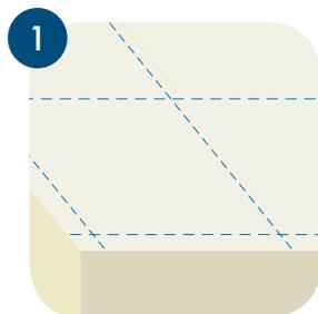
1 Делаем разметку уровня потолка и мест крепления подвесов. Шаг направляющих профилей 1200 мм, потолочных не более 600 мм.
