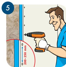
5 Зафиксируйте КНАУФ-листы саморезами к каркасу. Листы фиксируются с небольшим зазором от несущих стен, пола, потолка.
