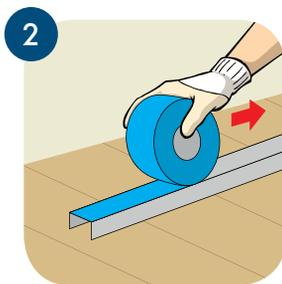
2 Наносим уплотнительную ленту КНАУФ. Лента наносится на наружную сторону направляющих профилей.
