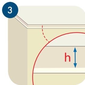
3 Наносим упругую прокладку на стены по периметру конструкции подвесного потолка. Высота конструкции (h) равна высоте конструкции потолка.
