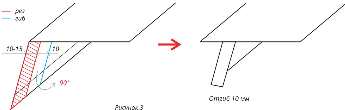
На верхней части, для стыковки с планкой верхнего карниза, сделайте рез на верхней полке под 45°. На нижней полке сделайте отгиб, как показано на рисунке 4.
