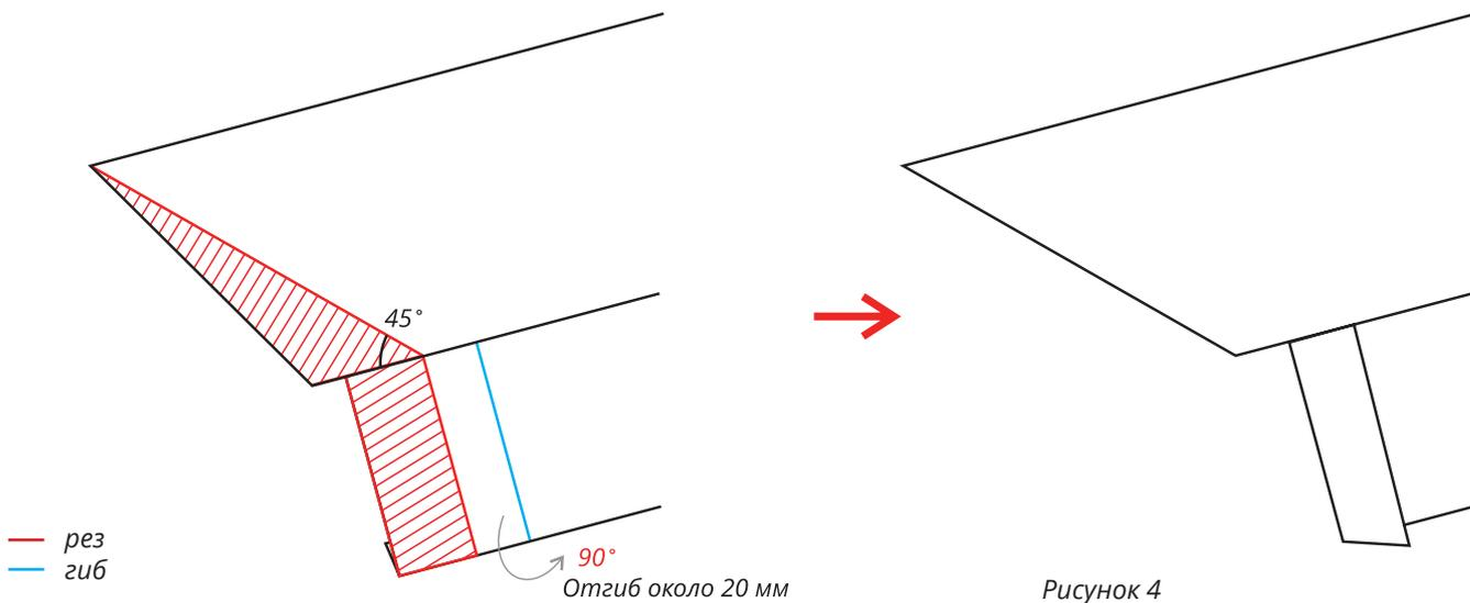
**3.** Подготовьте карнизную планку на примыкании верхнего карниза к торцу узла:
