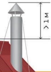
Выступающий над крышей дымоход высотой более 1 метра необходимо дополнительно укреплять растяжками, способными выдержать резкие порывы ветра.
