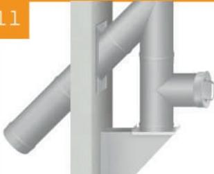
Необходимо своевременно очищать дымоход от продуктов сгорания, таких, как сажа, креозот, слабоконцентрированные кислотосодержащие соединения перед началом, в конце, а также в течение всего отопительного сезона не реже:
