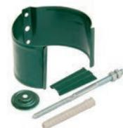
Предназначен для фиксации трубы на кирпичную, бетонную или каменную стену. Поставляется в комплекте с метизом длиной 160 мм под ключ/ биту Torx T25, дюбелем и декоративной накладкой.
