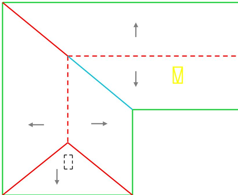
Нанесем на план кровли все имеющиеся у нас размеры элементов, уклоны всех скатов примем равными 45 градусов:
