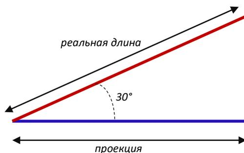
Если на плане кровли не указаны уклоны скатов, померить их можно с помощью транспортира по фасадам.
