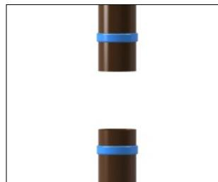
5. Установите дополнительные водосточные хомуты (не входят в комплектацию) для надежной фиксации трубы к фасаду здания
