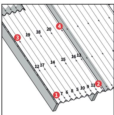
20 гвоздей на лист сначала по углам, потом в каждую волну по нижнему краю листа, потом в шахматном порядке через волну в двух средних линиях. Забивать гвоздь вертикально, в верх волны в нанесённые отметки.
