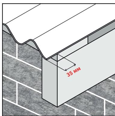
Правильный торцевой нахлест — 12 см\* (для уклона кровли 15°) образуется при совмещении обоих гидрозамков. Максимальный свес не более 35 мм, чтобы край листа не деформировался со временем.
