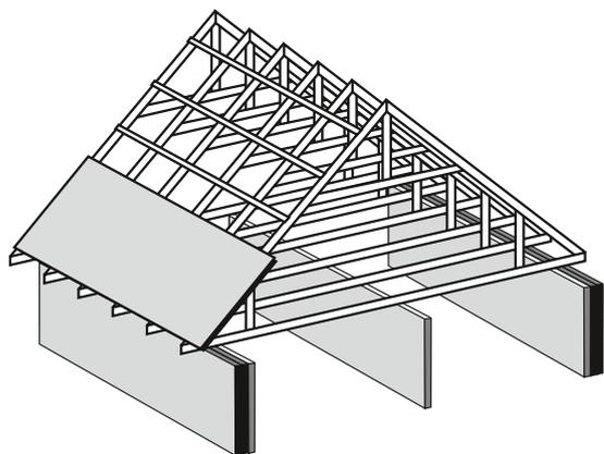
Зазор между плитами должен составлять 3-5 мм. Перед монтажом кровли следует подождать пока деревянные конструкции здания произведут усадку по всей площади (отдадут накопленную влагу), дабы исключить возможность образования волн и неровностей на смонтированной кровле.
