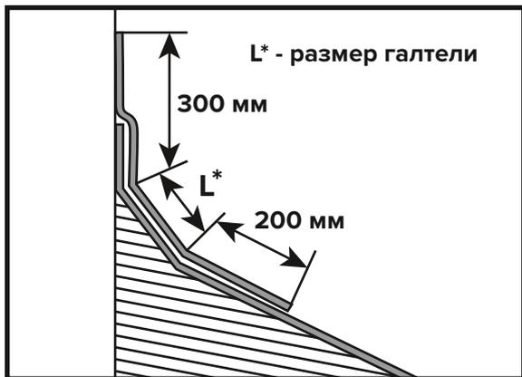
Для заведения на вертикальную поверхность используют Коньково-Ендовый ковер для Рулонной черепицы ТЕХНОНИКОЛЬ. Выкройки для заведения наверх следует укладывать внахлест не менее 200 мм на поверхность покрытия и с минимальным нахлестом 300 мм на заводимую поверхность, дополнительно закрепив материал специализированными краевыми прижимными планками. Верхний стык планки герметизируется кровельным герметиком. Размер галтели уточняется по месту.
