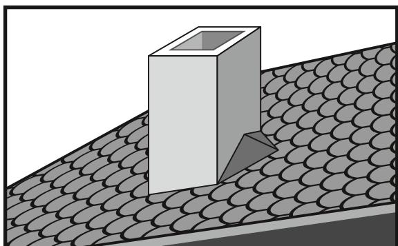
Для предотвращения скапливания снега за дымовыми и вентиляционными трубами, если их сечение превышает 500×500 мм и они расположены поперек ската, рекомендуется устанавливать разжелобок.
