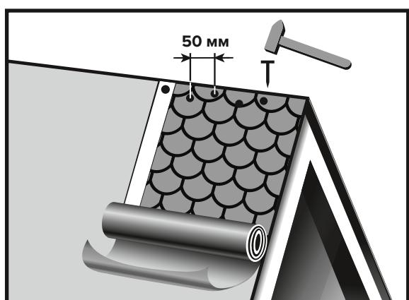
Перед началом монтажа необходимо очистить основание от мусора и пыли. При температуре наружного воздуха и основания 10-15°C для улучшения адгезии материала рекомендуется обработать поверхность битумным или латексным праймером.
