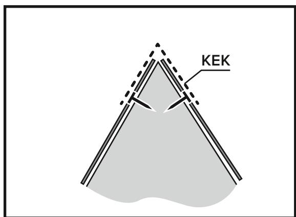
Аналогичным образом осуществляется монтаж второго ската кровли. Зона конька выполняется из Коньково-ендовного ковра ТехноНИКОЛЬ (KEK) согласно схемы устройства коньковых и реберных элементов.
