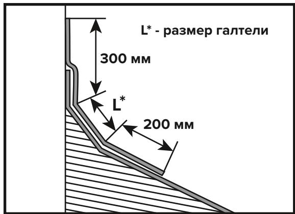
Для заведения на вертикальную поверхность используют Коньково-Ендовый ковер для Рулонной черепицы ТЕХНОНИКОЛЬ. Выкройки для заведения наверх следует укладывать внахлест не менее 200 мм на поверхность покрытия и с минимальным нахлестом 300 мм на заводимую поверхность, дополнительно закрепив материал специализированными краевыми прижимными планками. Верхний стык планки герметизируется кровельным герметиком. Размер галтели уточняется по месту.
