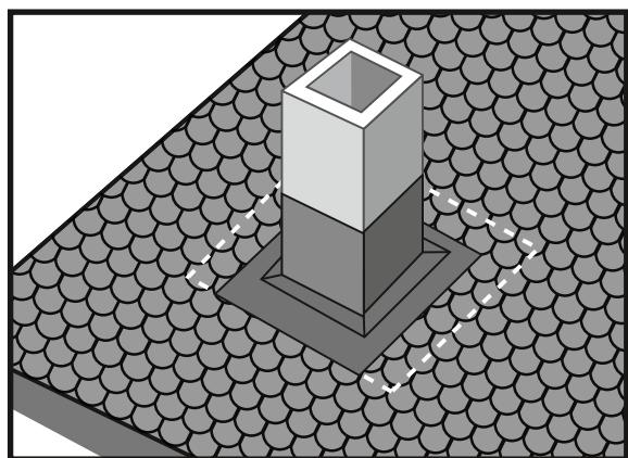
Полученные выкройкигибаютсяилинадрезаютсявопределенныеместах. Первоначально монтируется лицевая выкройка. Затем монтируется левая и правая выкройки. В последнюю очередь монтируется тыльная выкройка. При монтаже необходимо соблюдать принцип каскадности воды. Места сопряжения следуют проклеить битумной мастикой Фиксер на величину 100 мм. Верхняя часть выкроек по периметру дополнительно крепится специальными прижимными планками.
