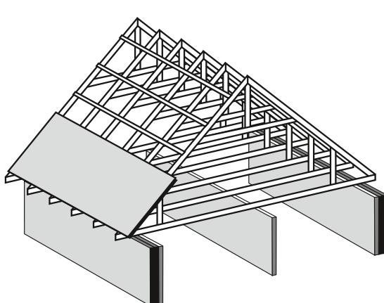
Зазор между плитами должен составлять 3-5 мм. Перед монтажом кровли следует подождать пока деревянные конструкции здания произведут усадку по всей своей площади (отдаст накопленную влагу), дабы исключить возможность образования волн и неровностей на смонтированной кровле.
