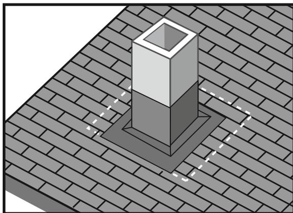
Полученные выкройки сгибаются или надрезаются в определенных местах. Первоначально монтируется лицевая выкройка. Затем монтируется левая и правая выкройки. В последнюю очередь монтируется тыльная выкройка. При монтаже необходимо соблюдать принцип каскадности воды. Места сопряжения следует проклеить битумной мастикой Фиксер на величину 100 мм. Верхняя часть выкроек по периметру дополнительно крепится специальными прижимными планками.
