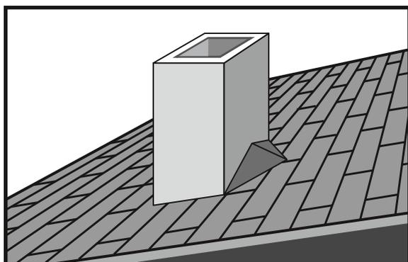
Для предотвращения скапливания снега за дымовыми и вентиляционными трубами, если их сечение превышает 500×500 мм и они расположены поперек ската, рекомендуется устанавливать разжелобок.
