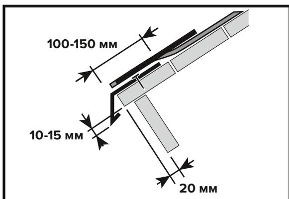
Карнизный свес кровли усиливается металлическими планками (капельниками). Они укладываются на край сплошного основания и крепятся специальными кровельными гвоздями в разбежку с шагом 120–150 мм, а в местах нахлестов 20–30 мм. Нахлест планок между собой составляет 30–50 мм. Поверхность планки обрабатывается тонким слоем Битумной мастики Фиксер, с последующей приклейкой к ней Рулонной черепицы ТЕХНОНИКОЛЬ.
