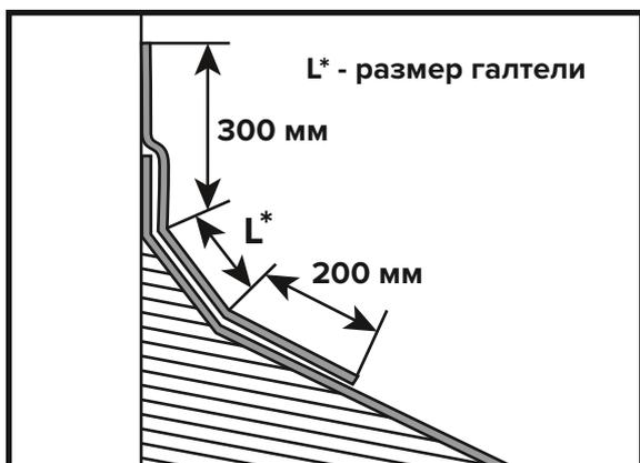
Для заведения на вертикальную поверхность используют Коньково-Ендовый ковер для Рулонной черепицы ТЕХНОНИКОЛЬ. Выкройку для заведения наверх следует укладывать внахлест не менее 200 мм на поверхность покрытия и с минимальным нахлестом 300 мм на заводимую поверхность, дополнительно закрепив материал специализированными краевыми прижимными планками. Верхний стык планки герметизируется кровельным герметиком. Размер галтели уточняется по месту.
