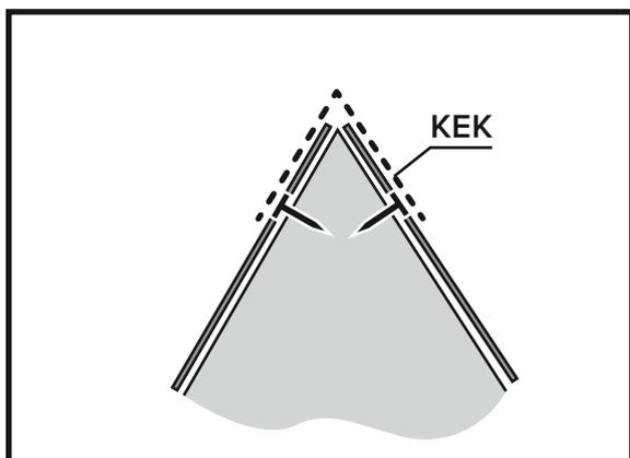
Аналогичным образом осуществляется монтаж второго ската кровли. Зона конька выполняется из Коньково-ендового ковра Технониколь (КЕК) согласно схемы устройства коньковых и реберных элементов.
